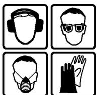
Indossare un equipaggiamento di protezione personale adatto: protezioni acustiche per la riduzione del rischio della sordità; occhiali protettivi; protezioni delle vie respiratorie per la riduzione del rischio di inalare polveri nocive per la salute; guanti di protezione per maneggiare l'attrezzo con gli utensili e con i materiali grezzi.
