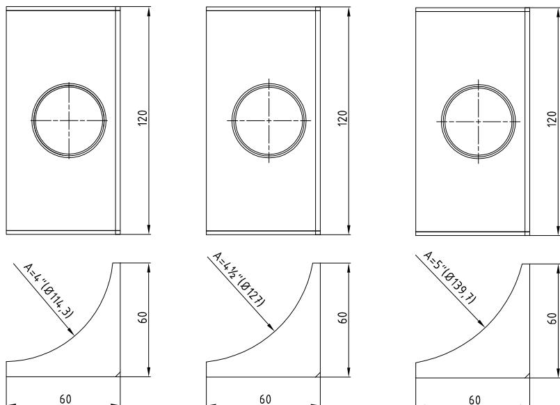
Attacchi in alluminio per le applicazioni a vite e attacchi in ferro per le applicazioni a saldare
